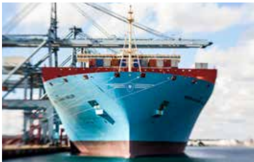
트리플-E급 넓이, U자형 선체, 그리고 더 볼록해진 이물 덕분에 더 많은 컨테이너를 운반할 수 있게 되었습니다.
