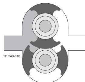
Le moyeu de chaque lobe en alliage anti-grippant tourne dans un évidement de la tête de pompe afin de réduire la flexion de l'arbre et ce, même à des pressions de refoulement élevées.
