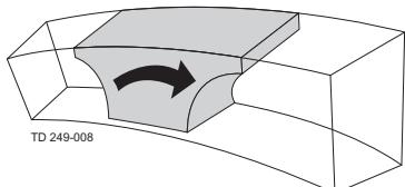
Les canaux profonds dans lesquels les lobes se déplacent créent des logements importants afin de réduire le cisaillement et l'écrasement des particules solides.
