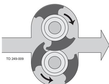
Les lobes sont composés d'alliage anti-grippant, permettant des jeux extrêmement faibles entre les surfaces en rotation et les surfaces fixes et garantissant ainsi une efficacité élevée et un dosage précis et ce, même pour les liquides fluides.
