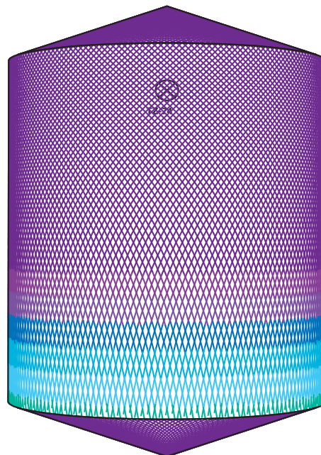
D5 м Н6 м, Toftejorg TZ-74 с функцией самоочищения, 4 x ø7 мм, 0% Время = 15.3 мин., Расход воды = 4853 л
