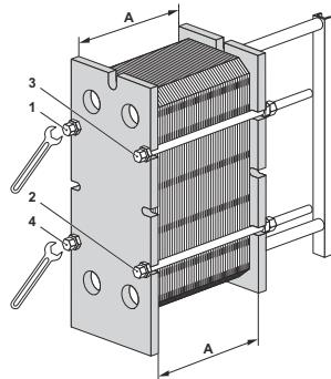
Разхлабете четирите стягащи болта (1), (2), (3), (4) диагонално, докато размерът на пакета пластини стане  $1,05 \times A$ , като се уверите, че при затваряне плочата в рамката и притискащата плоча са успоредни. Продължете редуването на всеки болт, докато всички остатъчни усилия на пакета пластини изчезнат. След това махнете болтовете.
