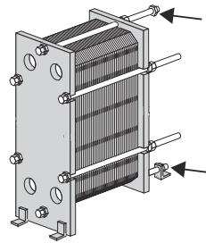
Сглобете в следния ред: шайби, гайки, външни краища на гредата, опорна пета на направляващата греда и гайки.
