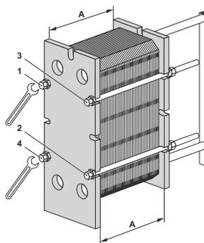
Desaperte os quatro parafusos de aperto (1), (2), (3), (4) diagonalmente até que a medida **A** do conjunto de placas seja de 1,05. Quando abrir, certifique-se de que a placa de armação e a placa de pressão estejam paralelas. Continue alternando entre cada parafuso até que todas as forças de reação do conjunto de placas tenham desaparecido. Em seguida, remova os parafusos.
