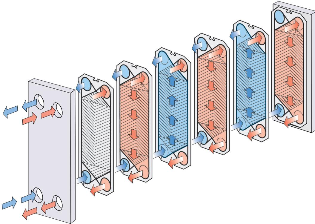
Figura 2: Exemplo de uma configuração de passagem única.
