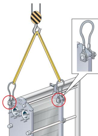
Figura 4: Dispositivo de elevação para AQ6, AQ4L, AQ6L, AQ8 e AQ8S.
