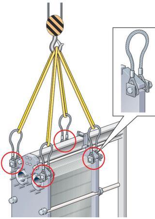
**Figura 5: Dispositivo de elevação para AQ10T e AQ10.**
