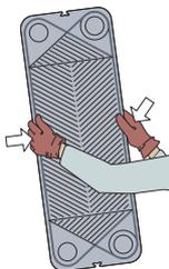
Abra a pilha de placas deixando a placa de pressão deslizar sobre a barra transportadora.
